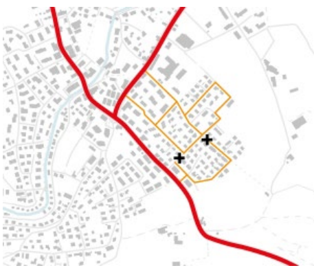
Abbildung 8: stabiles Netz am Beispiel Quartier Ländli. Unterbrüche an geeigneten Stellen verhindern eine Durchfahrt durch das Quartier, sowohl für Schleichverkehr aber auch für Ziel- Quellverkehr. Verkehrsaufkommen und Zufahrtswege sind kontrolliert und daher als stabil zu bezeichnen.
