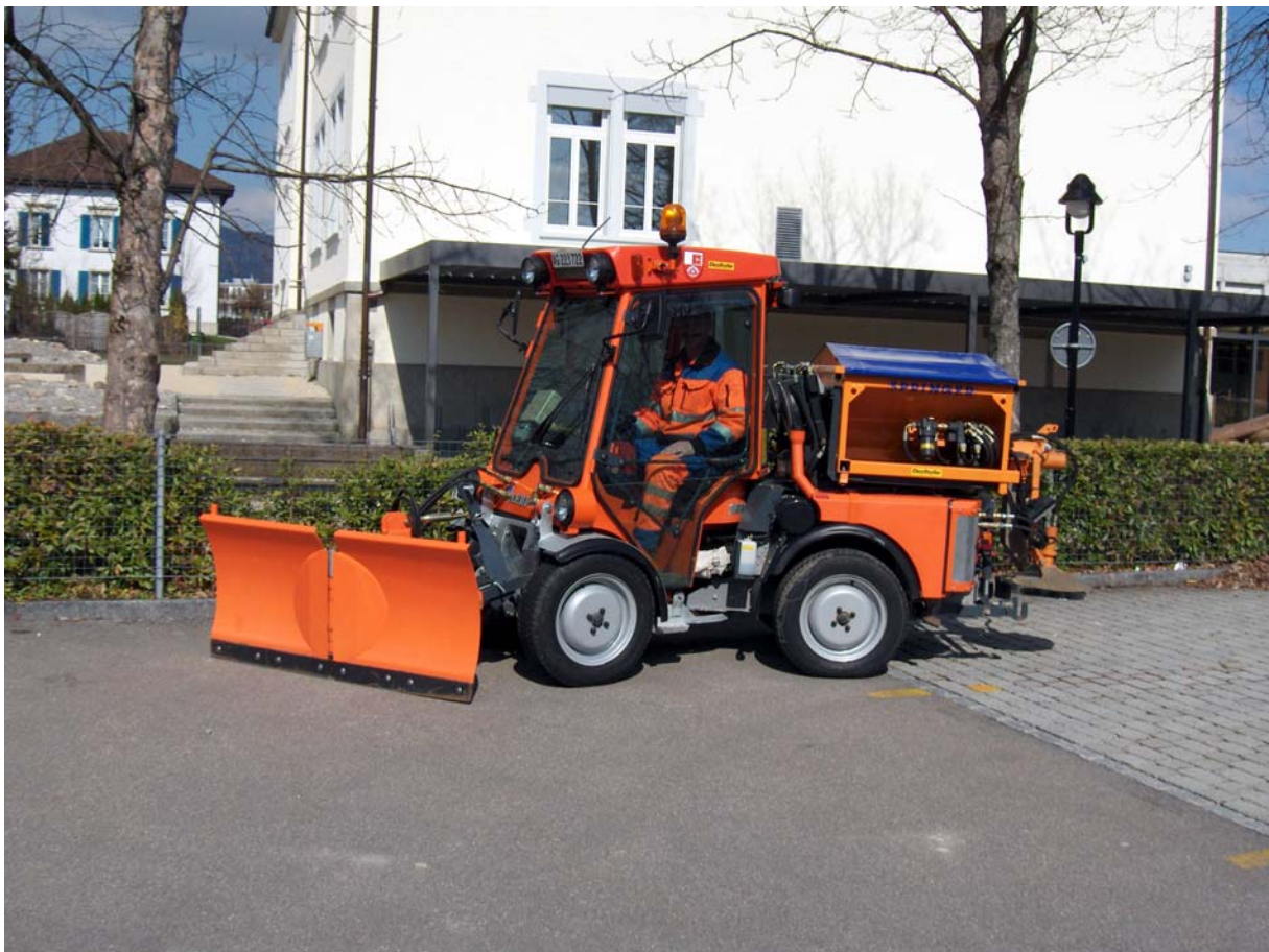
Der neue Geräteträger Aebi KT-50 mit Winterdienstausrüstung (Schneepflug und Salzstreuer)
