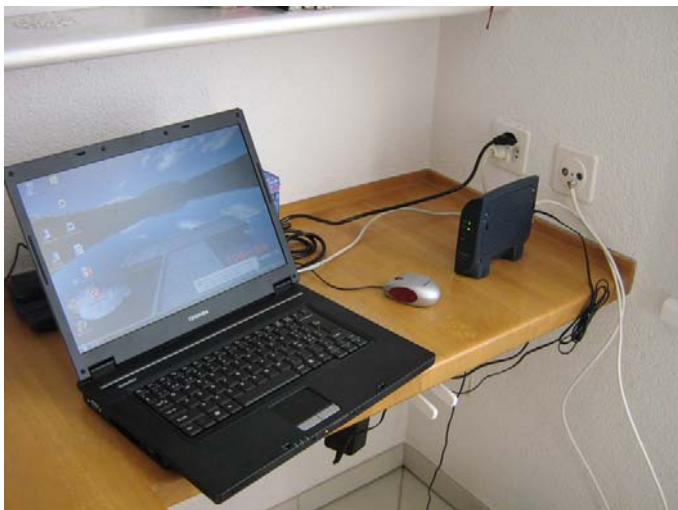
Einfacher Anschluss ans Internet über das Kommunikationsnetz Würenlos mithilfe der Anschlussbuchse und eines Modems.
