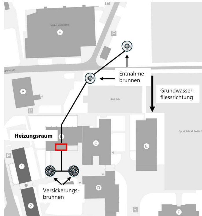
Abbildung 12: Situation Grundwasserfassung und Heizungsraum am Standort 1
