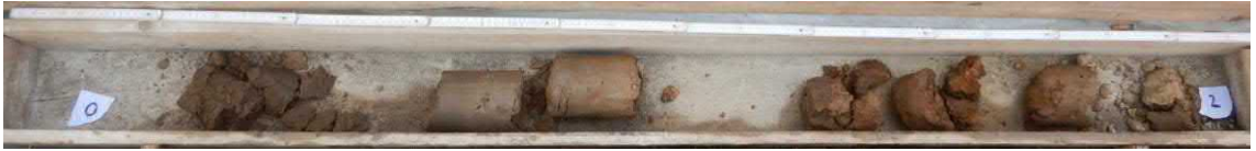
Foto 1: Kernbohrung 20-1: 0 m bis 2 m
