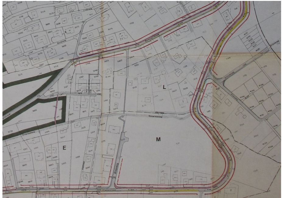
Abbildung: Ausschnitt aus dem rechtskräftigen kommunalen Überbauungsplan Altwies – Buech aus dem Jahr 1979. Buechzelglistrasse und Altwiesenstrasse sollten je mit einem Querschnitt von 5.0m Fahrbahn und 1.5m (Buechzelglistrasse) und 2.0m (Altwiesenstrasse) Trottoir ausgebaut werden. Während dies in der Altwiesenstrasse grösstenteils erfolgt ist, ist der Aufwand zur Herstellung einer für eine Sammelstrasse tauglichen Verbindung in der Buechzelglistrasse ungleich grösser.
